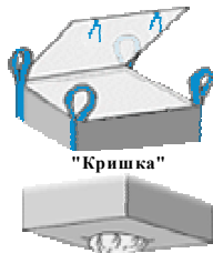
"U" - тіло контейнера формується з трьох полотен (одне - дві стінки і дно, та два - ще дві стінки).
